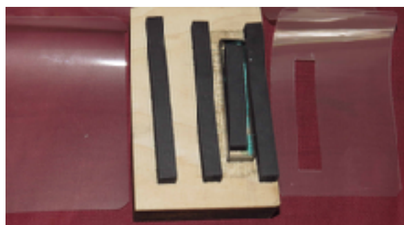
A gauche le plastique entier Au milieu, l'emporte pièce manuel, A droite, le plastique découpé...
